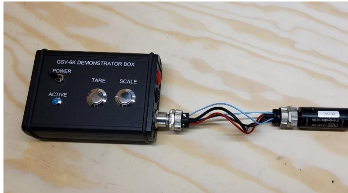
GSV-6K Demonstrator Box connecté au GSV-6K coté output
