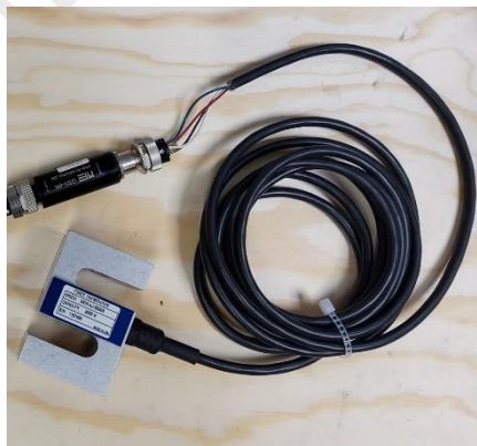
Capteur connecté au côté sensor du GSV-6K
